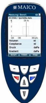
Obere Tastenreihe: Die Funktion der Tasten wird im Display, oberhalb der entsprechenden Taste angezeigt (z. B. Teststart, Patient, Stopp).
