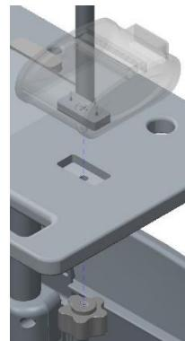
3. Проведите кабель питания принтера через сквозное отверстие за принтером и подключите его к зарядному гнезду на правой стороне принтера.
