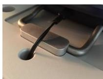
3. Закрепите пластину-стабилизатор на металлической рейке зарядной подставки винтами.
