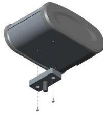
2. Вставьте принтер вместе со специальной пластиной в карман и закрепите его шарообразной ручкой.
